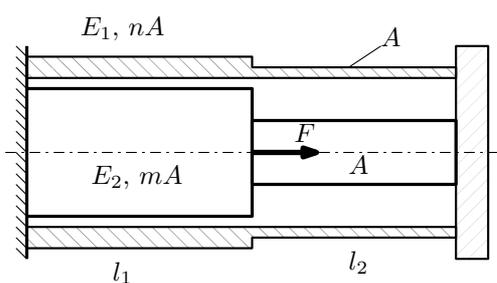
Трубка и стержень одним торцом заделаны, а с другого скреплены абсолютно жёсткой плитой. Материал трубки — сталь, материал стержня — алюминий. Для заданной конструкции:
