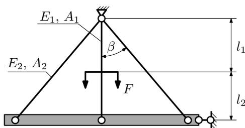
Найти допустимую силу  $F$  из условия прочности. При найденной силе определить перемещение абсолютно жесткого тела.
