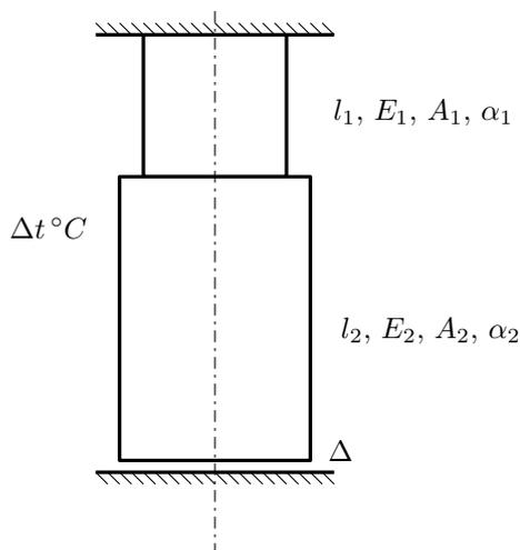
До нагрева между торцом колонны и абсолютно жесткой плитой существует зазор  $\Delta$ .
