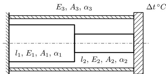
Стержень и трубка заделаны с одного торца, а с другого скреплены абсолютно жесткой плитой. Построить эпюры  $N$ ,  $\sigma$ ,  $w$  отдельно для трубки и стержня после нагрева трубки на  $\Delta t^\circ C$ . Найти коэффициент запаса конструкции.
