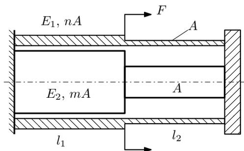
Трубка и стержень одним торцом заделаны, а с другого скреплены абсолютно жёсткой плитой. Материал трубки — сталь, материал стержня — латунь. Для заданной конструкции:
