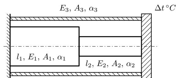
Стержень и трубка заделаны с одного торца, а с другого скреплены абсолютно жесткой плитой. Найти допустимую температуру  $\Delta t$  нагрева трубки и построить эпюры  $N$ ,  $\sigma$ ,  $w$  отдельно для трубки и стержня.
