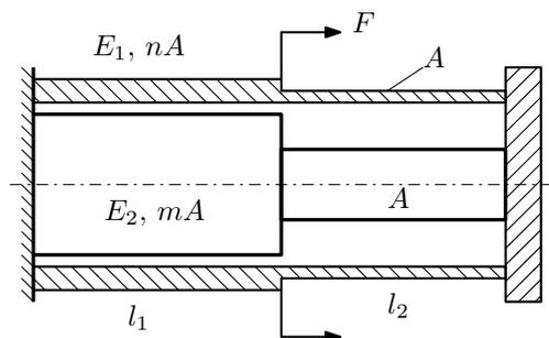
Трубка и стержень одним торцом заделаны, а с другого скреплены абсолютно жёсткой плитой. Для заданной конструкции:
