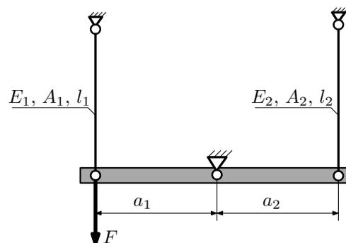
Брус, весом и податливостью которого следует пренебречь, закреплен неподвижным шарниром и двумя тягами. Вычислить усилия и напряжения в тягах для заданного значения  $F$ . Найти коэффициент запаса конструкции.
