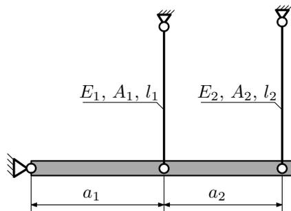
Абсолютно жесткое тело, весом которого следует пренебречь, закреплено неподвижным шарниром и двумя тягами. Считая, что в действительности длина второй тяги меньше указанной на заданную величину  $\Delta$ , найти коэффициент запаса конструкции.
