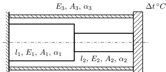
Стержень и трубка заделаны с одного торца, а с другого скреплены абсолютно жесткой плитой. Найти допустимую температуру  $\Delta t$  нагрева стержня и построить эпюры  $N$ ,  $\sigma$ ,  $w$  отдельно для трубки и стержня.
