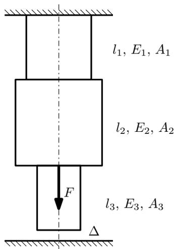
До нагружения между торцем колонны и абсолютно жесткой плитой существует зазор  $\Delta$ .
