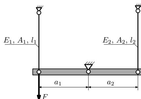
Брус, весом и податливостью которого следует пренебречь, закреплен неподвижным шарниром и двумя тягами. Найти допускаемую величину силы  $F$  из условия прочности. Вычислить усилия и напряжения в тягах для найденного значения  $F$ .
