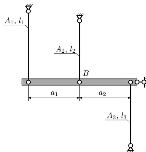
Брус, податливостью которого следует пренебречь, закреплен тремя тягами. Найти коэффициент запаса конструкции при нагреве третьей тяги на  $\Delta t$ .
