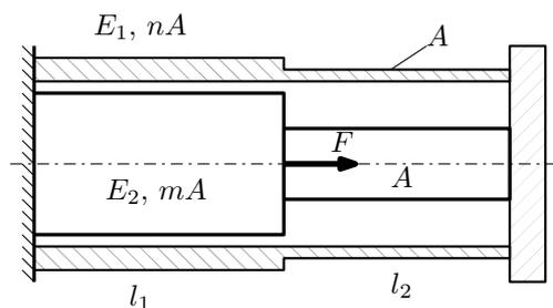
Трубка и стержень одним торцом заделаны, а с другого скреплены абсолютно жёсткой плитой. Материал трубки — медь, материал стержня — сталь. Для заданной конструкции:
