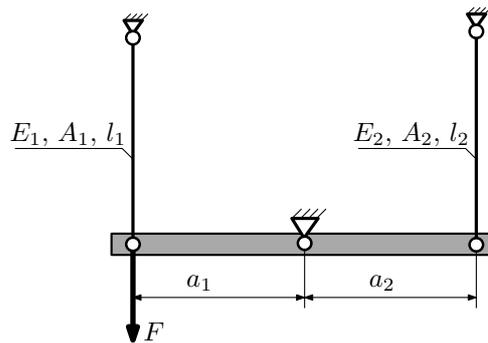
Брус, весом и податливостью которого следует пренебречь, закреплен неподвижным шарниром и двумя тягами. Вычислить усилия и напряжения в тягах для заданного значения  $F$ . Найти работу внешних сил  $W$  и потенциальную энергию деформации  $U$ .
