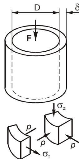
Используя критерий Хубера-Мизеса и подставив исходные данные, получаем:  $\sigma_z \approx 200$  МПа (сжатие),  $\sigma_t = 19.5$  МПа (растяжение),  $p = 0.975$  МПа (сжатие). Теперь, даже не подсчитывая модуль деформации по формуле (2), можно увидеть, что осевое напряжение, по модулю существенно большее всех прочих, входит со знаком плюс, обеспечивая положительную величину окружной деформации. Это – пусть косвенная и ненадежная, но все же проверка.
