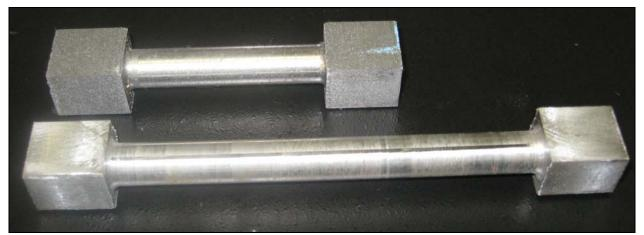
Фото 4.1 Пример образцов из чугуна и стали, применяемых при проведении лабораторных работ
