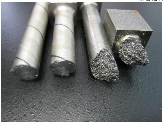
Фото 8.9. Сравнение характера разрушения. Слева – сталь, справа - чугун.
